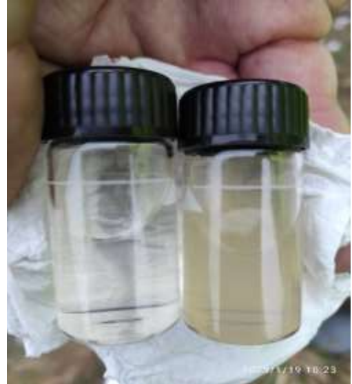
Kuva 13a-b. Pellon piennar on mennyt rikki. Kuvassa vasemmanpuoleinen vesinäyte (48 FNU) on otettu ennen noroa ja oikeanpuoleinen samea näyte (369 FNU) noroutumiskohdan jälkeen. Kiintoainekuormitus aiheuttaa veden sameutta ja kiintoaineen mukana veteen päätyy myös ravinteita.
