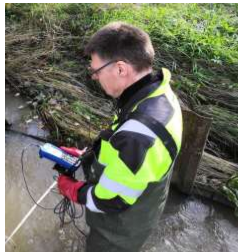
Kuva 12a-b. Virtaamien mittaamista OTT:n siivikoilla. Vasemmanpuoleisessa kuvassa mekaaninen siivikko ja oikeanpuoleisessa magneetti-induktioon perustuva siivikko (Matti Jantunen/Pasi Salmi).
