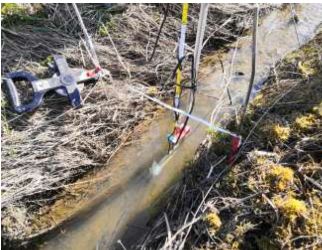
Kuva 12a-b. Virtaamien mittaamista OTT:n siivikoilla. Vasemmanpuoleisessa kuvassa mekaaninen siivikko ja oikeanpuoleisessa magneetti-induktioon perustuva siivikko (Matti Jantunen/Pasi Salmi).
